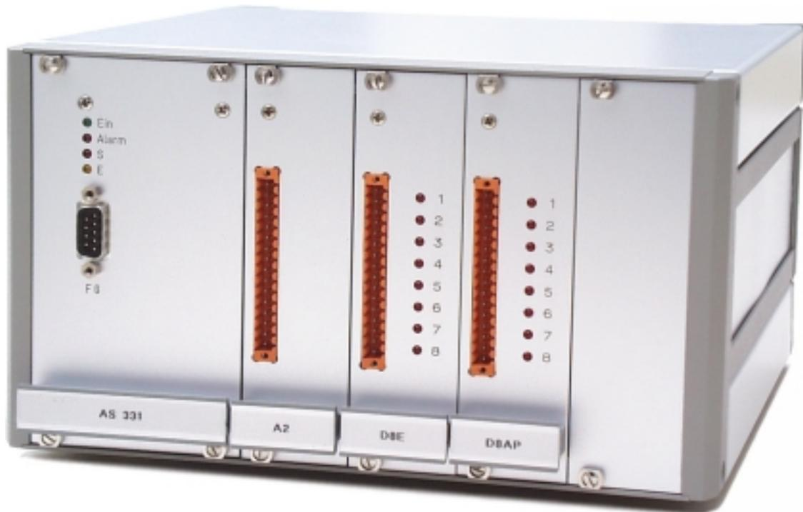
Die Unterstation AS 331 kann je nach Gehäusegröße mit vier oder sieben Ein- und Ausgabekarten bestückt werden. Über eine Bus-Struktur kann eine praktisch beliebige Anzahl weiterer Ein- und Ausgabemodule angeschlossen werden.
